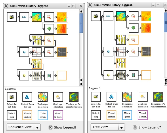
Abbildung 7.11: Darstellung der Analysehistorie im Visualisierungsdesign-Wizard: links: sequenzielle Abfolge; rechts: logische Abhängigkeiten
