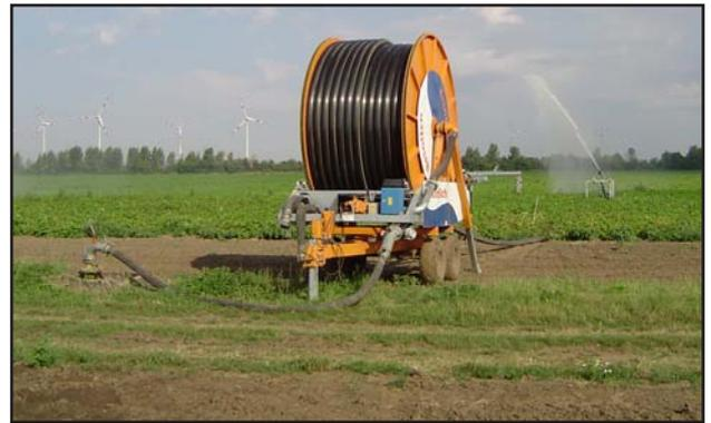
Abb. 38: Schlauchberegnungsmaschine mit Regnereinzug bei Wanzleben im Juli 2008 zur Beregnung von Kartoffeln (Foto: M. Simon)
