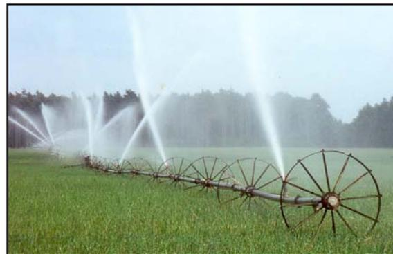
Abb. 7: Rollbare Regnerflügel im Einsatz
