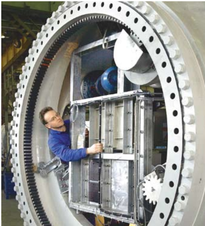
Schauplatz Produktionshalle von Nordex: Ein Elektriker kontrolliert die Leitungen im Innern der Nabe. Foto: dpa
