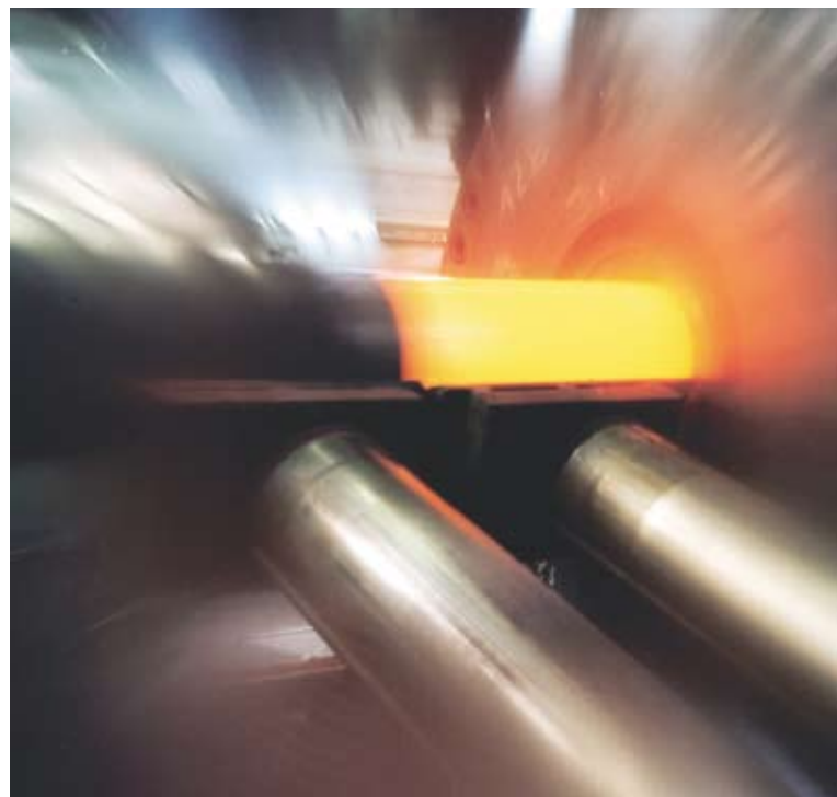
Ein Kupferbolzen wird in die Rohrpresse geschoben.
