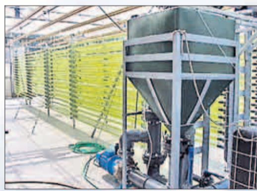
Eine ungewöhnliche Methode der Kohlendioxid-Abscheidung wird an der Internationalen Universität Bremen erprobt: Das Gas wird von Algen in einem Bioreaktor zu Biomasse aufgebaut, die dann zu Baustoffen weiterverarbeitet werden kann
